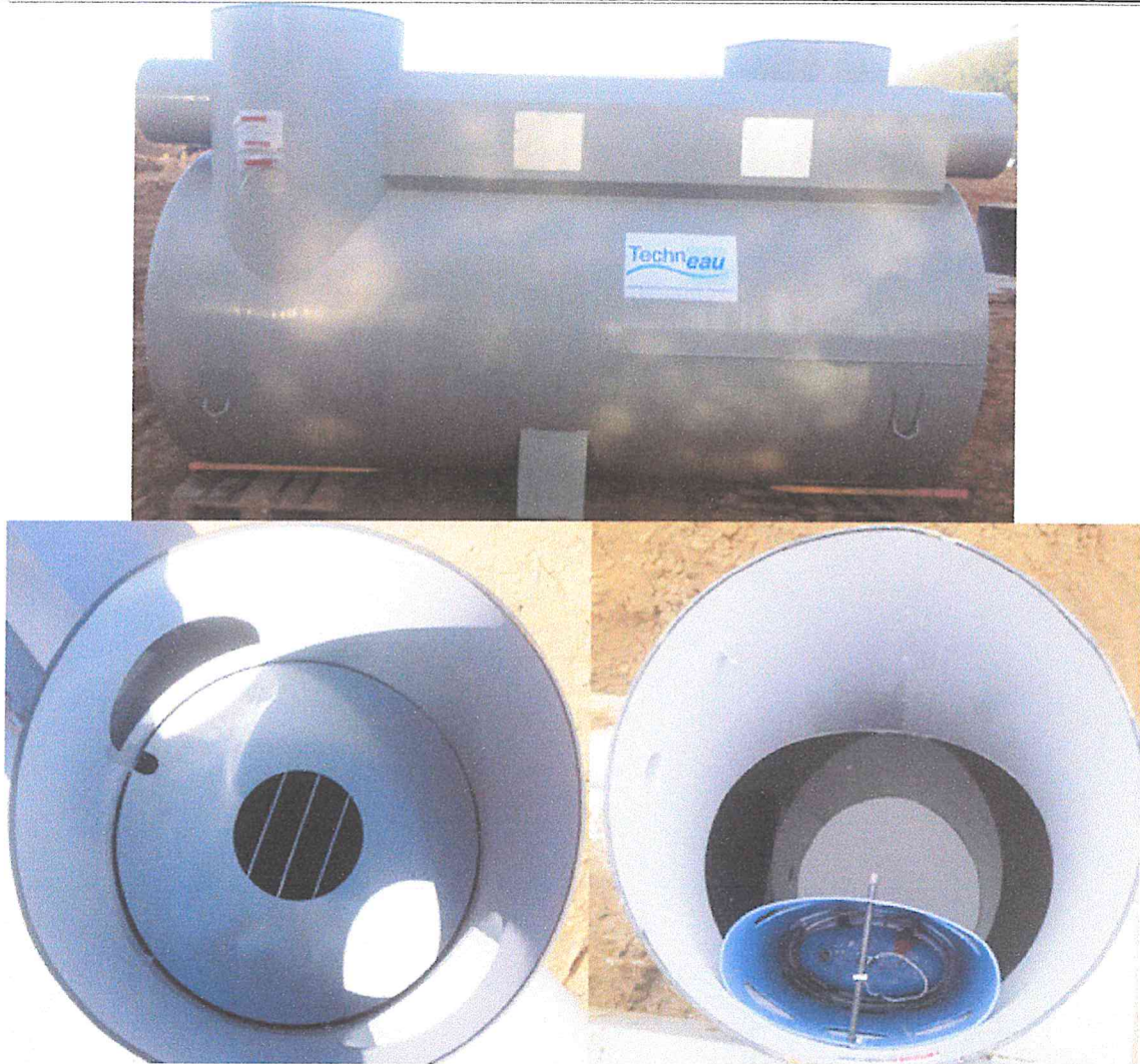
5 pav. Standartinis plieninis naftos produktų skirtuvas su integruotu smėlio ir purvo nusodintuvu, apibėgimo linija ir automatiniu avariniu uždoriu. (kairėje smėlio ir purvo nusodintuvas su apsauginėmis grotelėmis; dešinėje naftos produktų skirtuvas su automatiniu avariniu uždoriu).
