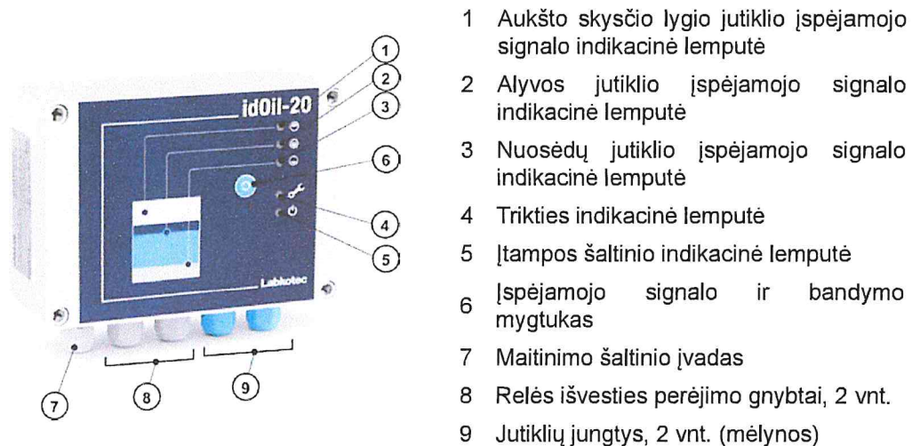
Paveikslas 17. Valdymo įrenginio „idOil“ funkcijos
